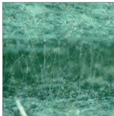
Abb. 7: Schimmelpilze auf PK 59 (H40), 40-fache Vergrößerung
